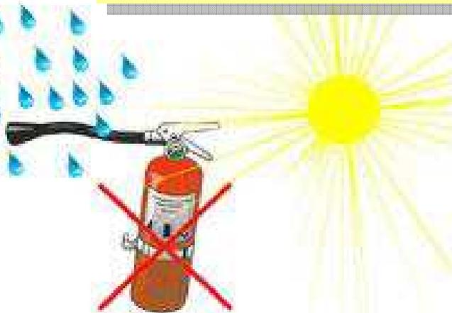
► виключити можливість потрапляння прямих сонячних променів та опадів на засіб пожежегасіння
